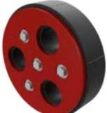
Уплотнитель высоковольтного кабеля «РЭДПАЙП» УВК-3 предназначен для монтажа 3 кабельных линий. Уплотняя пространство между кабелями и трубой, уплотнитель изолирует кабели от проникновения грунтовых вод и заливания.
